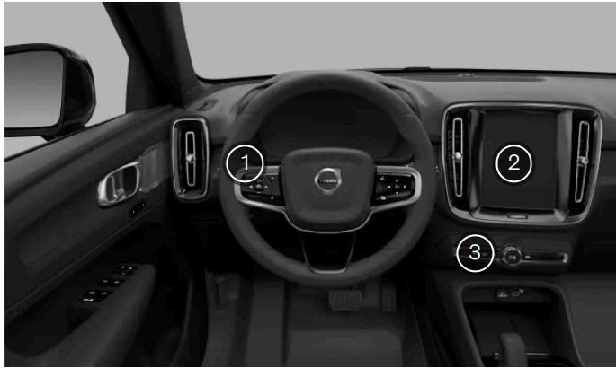
Plassering av kontroller for utvendig belysning
