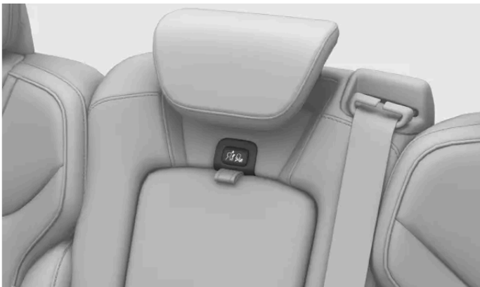
Sperreknapp på den midtre hodestøtten
