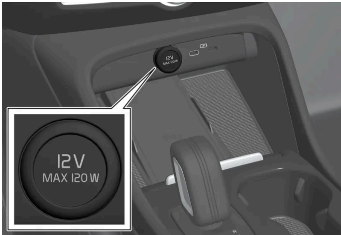
12 V strømuttak i tunnelkonsoll, forsete.
