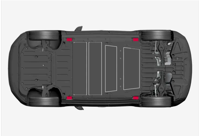
Bilens løftepunkter for løfting med jekk
