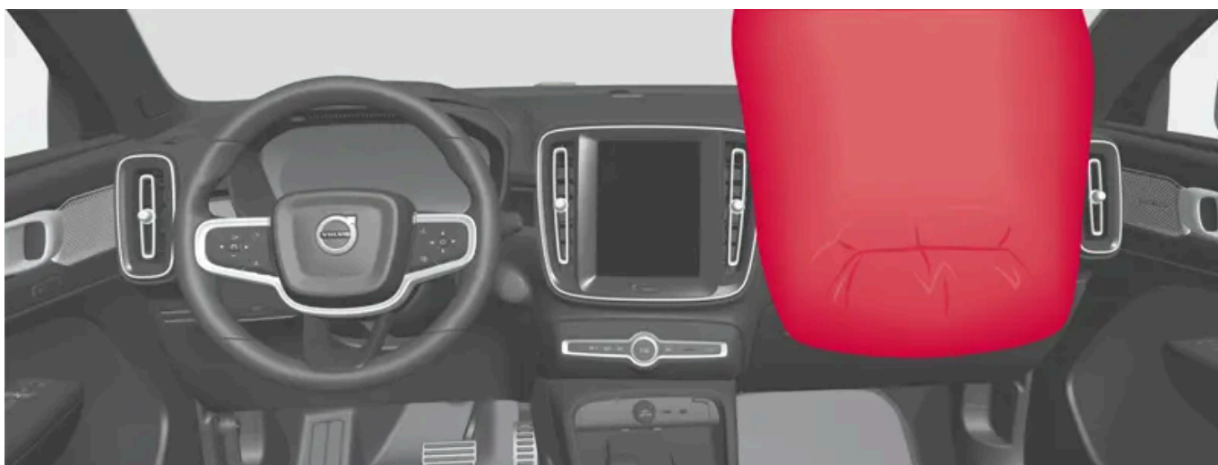
Kollisjonspute på passasjersiden i forsetet.
