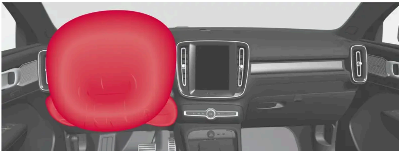
Rattkollisjonspute og knekollisjonspute [1] på førersiden i forsetet.
