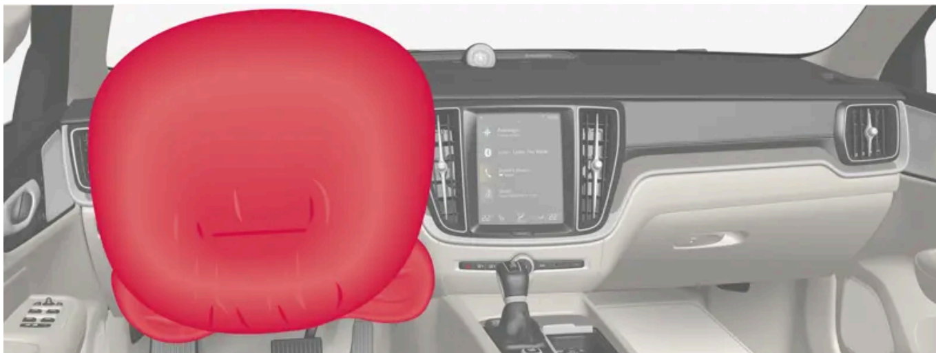
Rattkollisjonspute og knekollisjonspute [1] på førersiden i forsetet.
