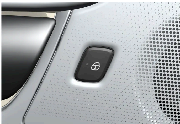
Låseknapp med indikatorlampe i bakdør.
