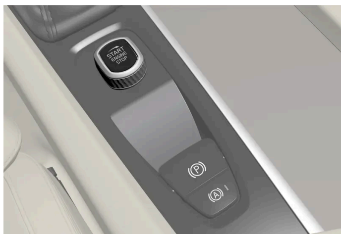
Startbryteren i tunnelkonsollen.
