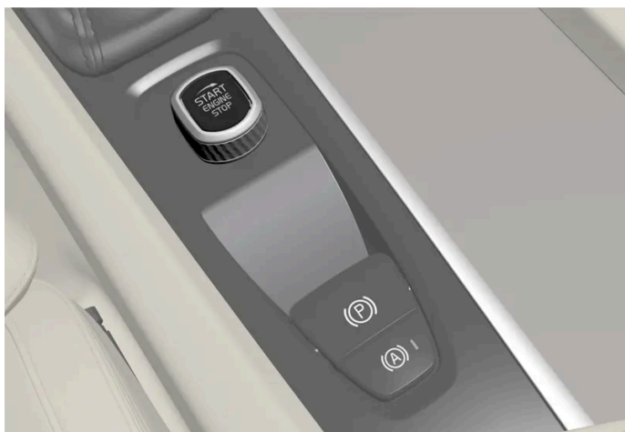
Startbryteren i tunnelkonsollen.
