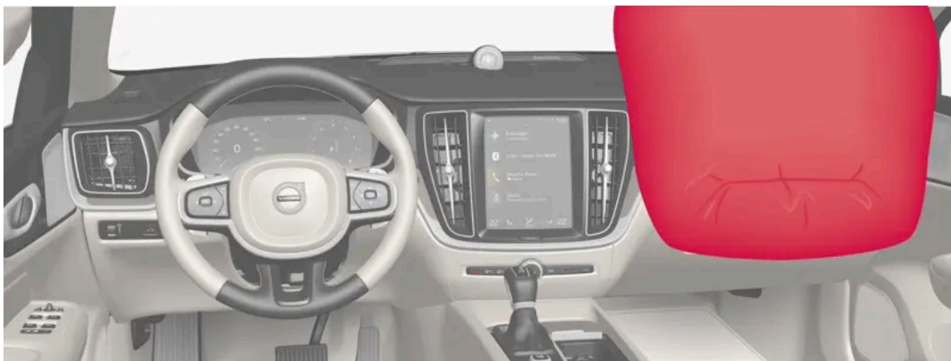
Kollisjonspute på passasjersiden i forsetet.
