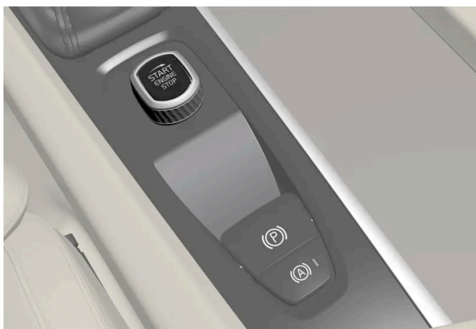
Startbryteren i tunnelkonsollen.
