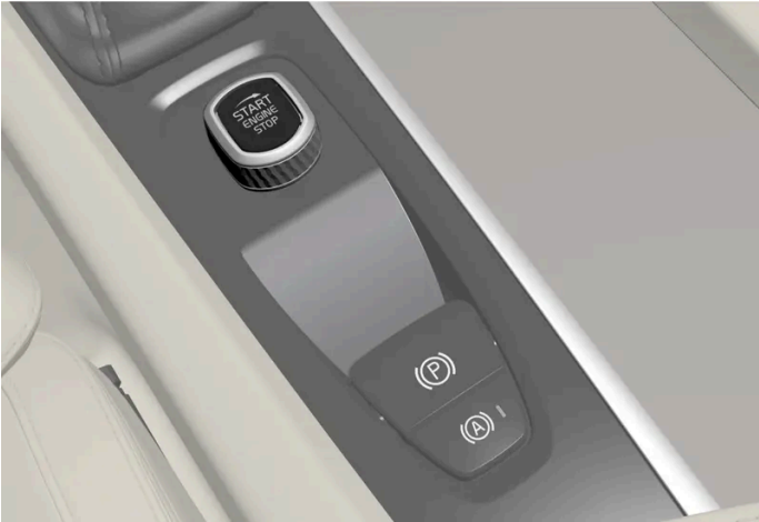
Startbryteren i tunnelkonsollen.
