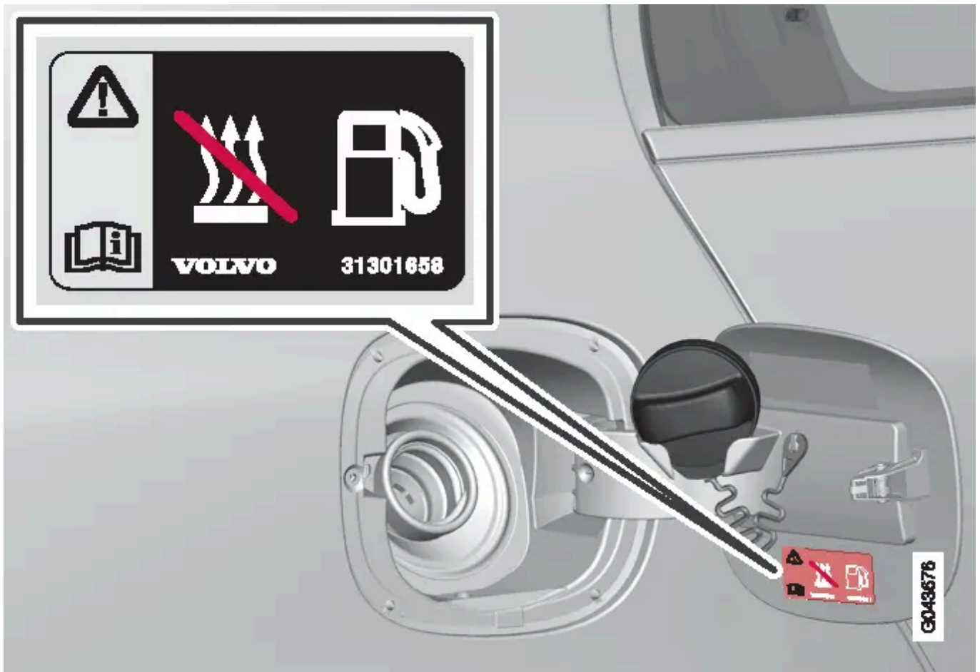
Varselmerke på tanklokket.
