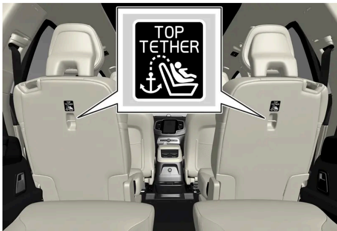
6-seters variant: Festepunktene plassering for den andre seteraden angis av symboler på baksiden av seteryggen.
