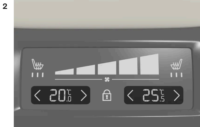
Temperaturbryter på klimapanelet bakpå tunnelkonsollen.
