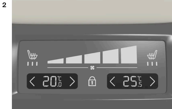
Temperaturbryter på klimapanelet bakpå tunnelkonsollen.
