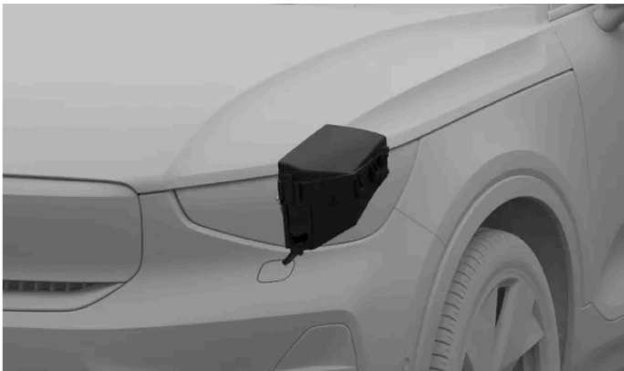
Położenie skrzynki bezpieczników
