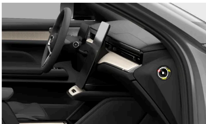
Położenie przełącznika poduszki powietrznej pasażera
