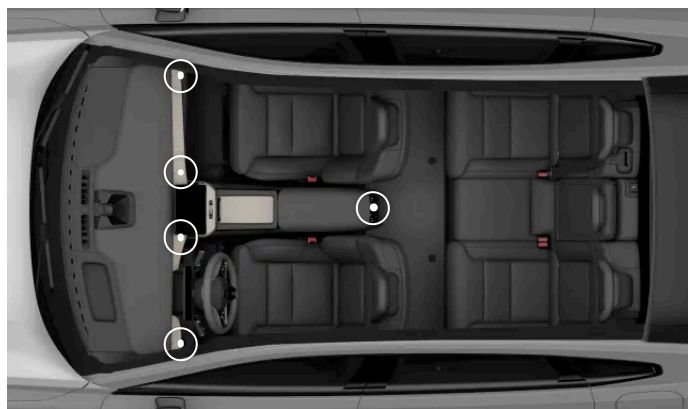
Rozmieszczenie regulowanych nawiewów
