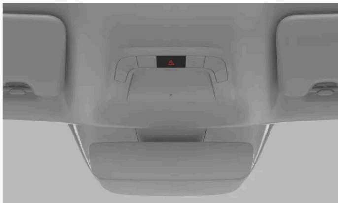
Położenie przycisku światła awaryjnych na konsoli sufitowej
