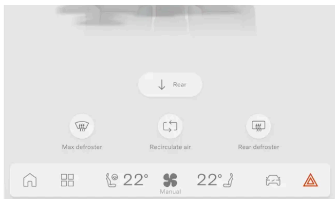
Położenie przycisku światła awaryjnych na wyświetlaczu centralnym
