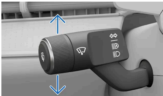
Wskaźniki na lewej dźwigni
