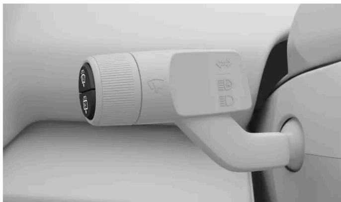
Przyciski spryskiwaczy na lewej dźwigni przy kierownicy.
