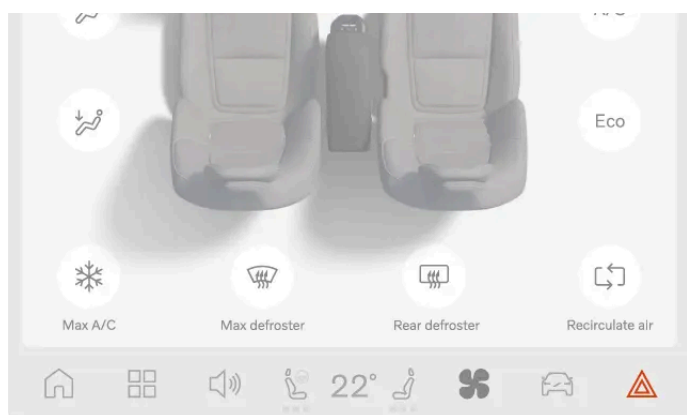
Położenie przycisku świateł awaryjnych na wyświetlaczu
