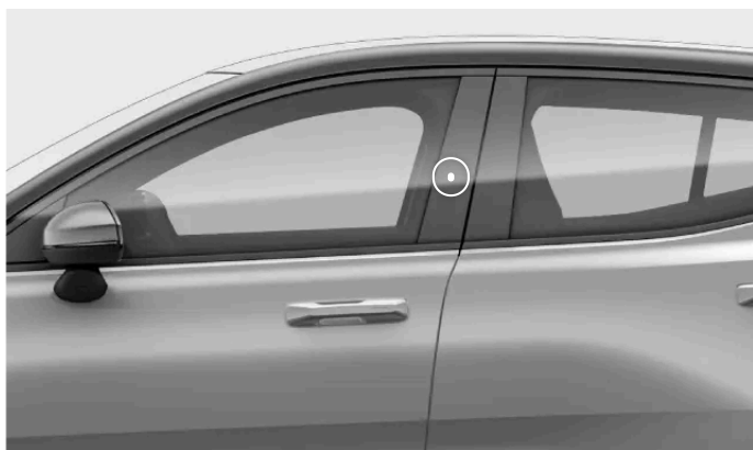
Obszar wykrzywania kluczyka na słupku drzwiowym
