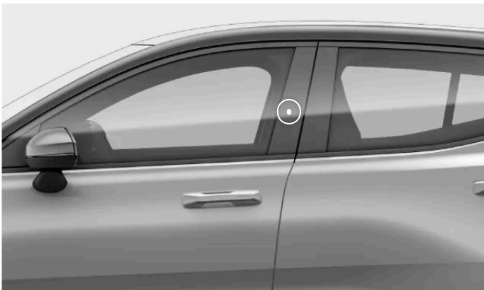
Obszar wykrywania kluczyka na słupku drzwiowym
