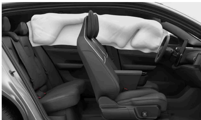
Kurtyna powietrzna rozwinięta po jednej stronie samochodu.
