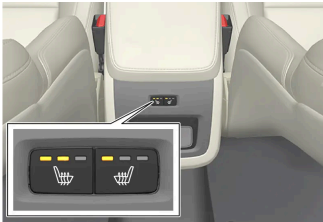
Przyciski podgrzewania siedzeń z tyłu konsoli między fotelami.
