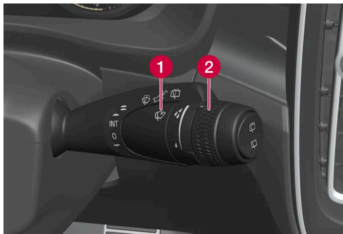
Prawa dźwignia przełącznika zespolonego przy kierownicy.
