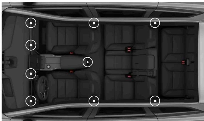
Rozmieszczenie regulowanych nawiewów
