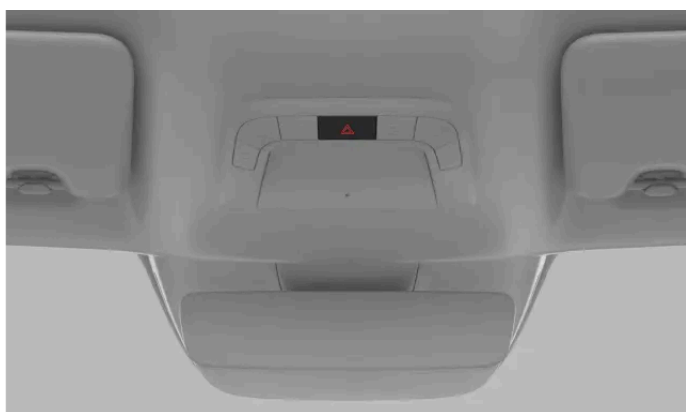
Położenie przycisku światła awaryjnych na konsoli sufitowej
