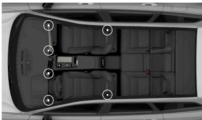
Rozmieszczenie regulowanych nawiewów
