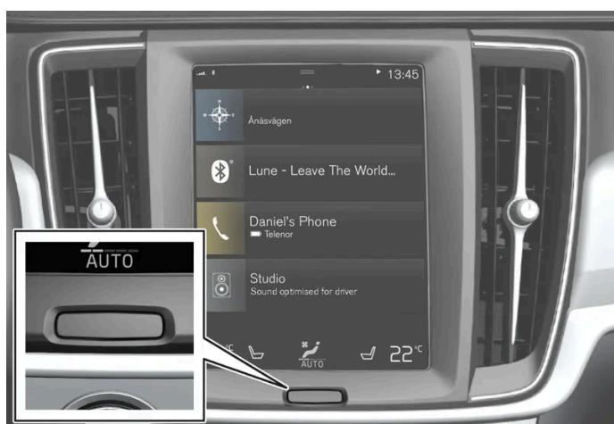
Przycisk strony głównej wyświetlacza centralnego.
