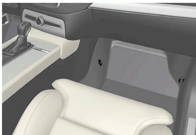
Rozmieszczenie zaczepów mocujących w fotelu przednim.
