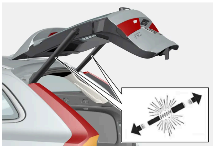
Sprężyny gazowe do sterowanych elektrycznie drzwi bagażnika.
