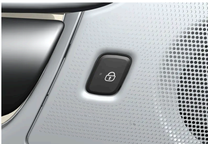
Przycisk centralnego zamka ze wskaźnikiem diodowym w drzwiach tylnych.
