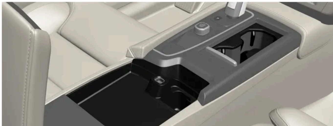
Schowki z uchwytem na napoje, gniazdem elektrycznym oraz gniazdami USB w konsoli między fotelami.
