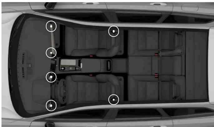
Rozmieszczenie regulowanych nawiewów
