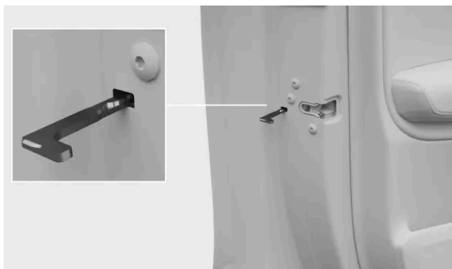
Położenie mechanizmu resetowania zamka
