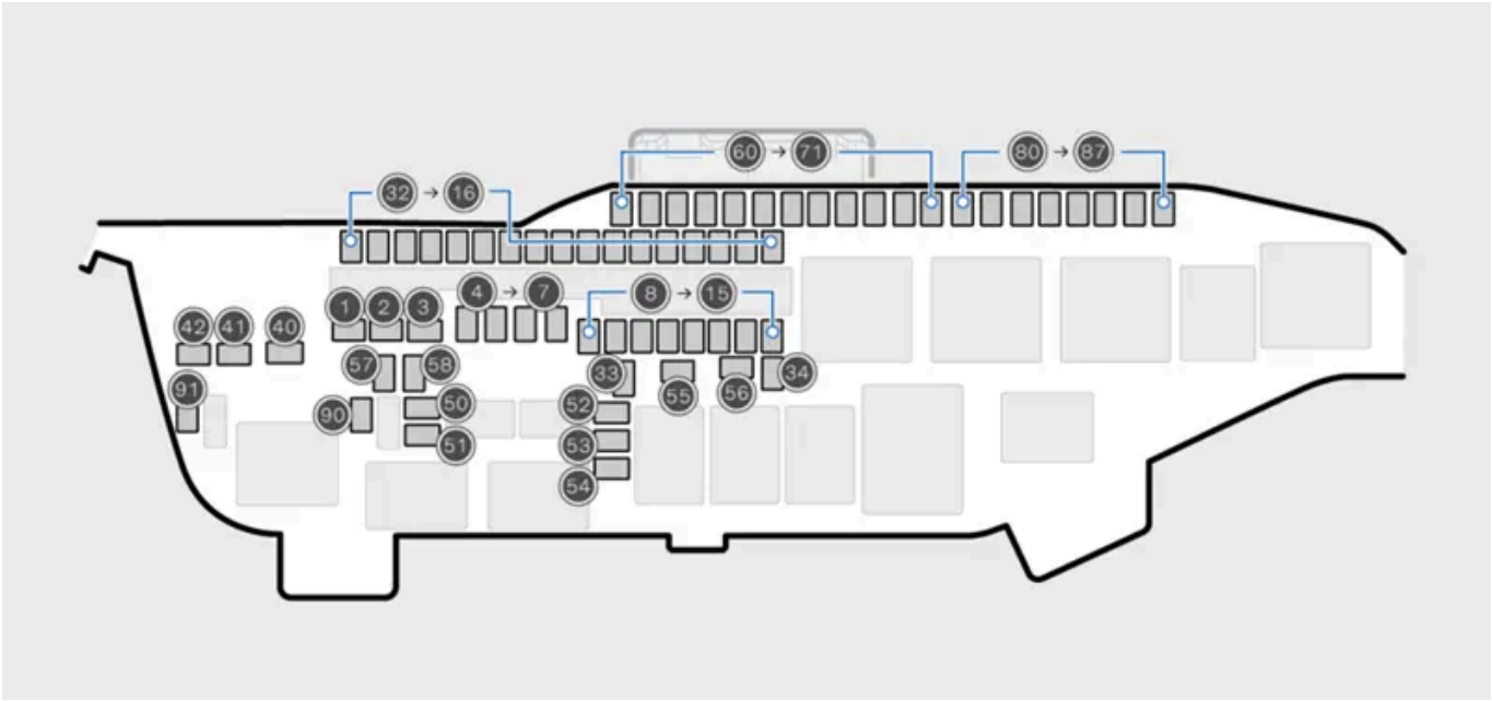
Schemat przedstawiający rozmieszczenie bezpieczników
