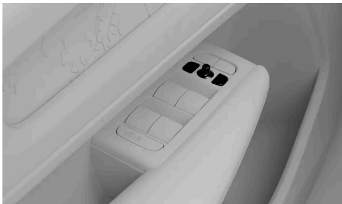
Elementy sterujące regulacją lusterek bocznych
