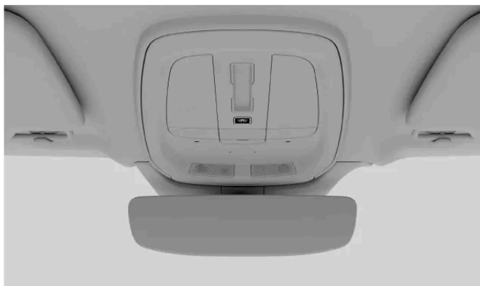
Przycisk automatycznego wyłączania oświetlenia na konsoli sufitowej
