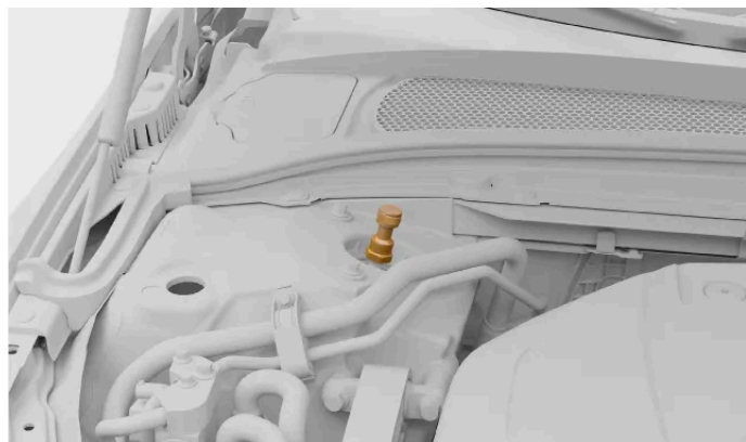
Pokrętła regulacyjne zawieszenia kół przednich znajdują się pod maską.
