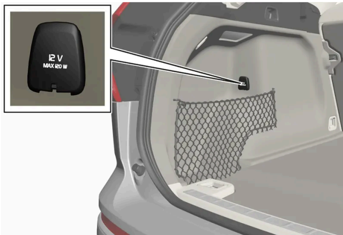
Gniazdo elektryczne 12 V w przestrzeni bagażowej*.
