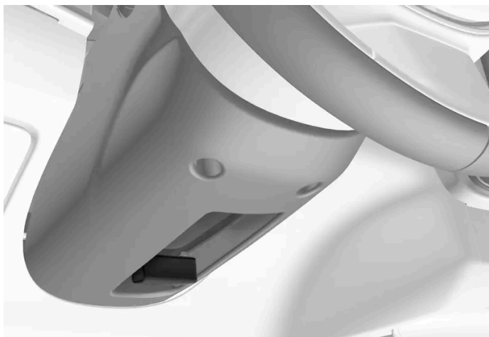
Dźwignia do regulacji kierownicy.
