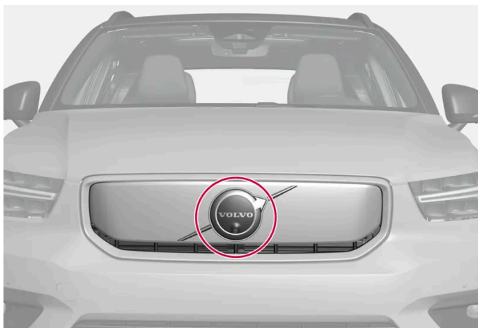
Umieszczenie przedniego modułu radarowego
