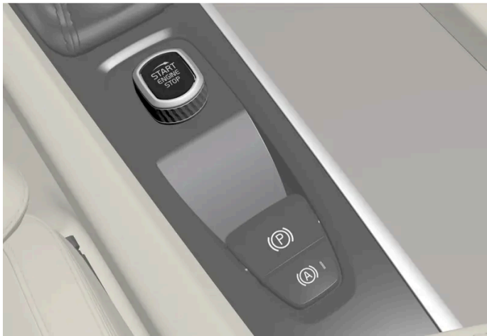
Pokrętko rozruchu na konsoli między fotelami.
