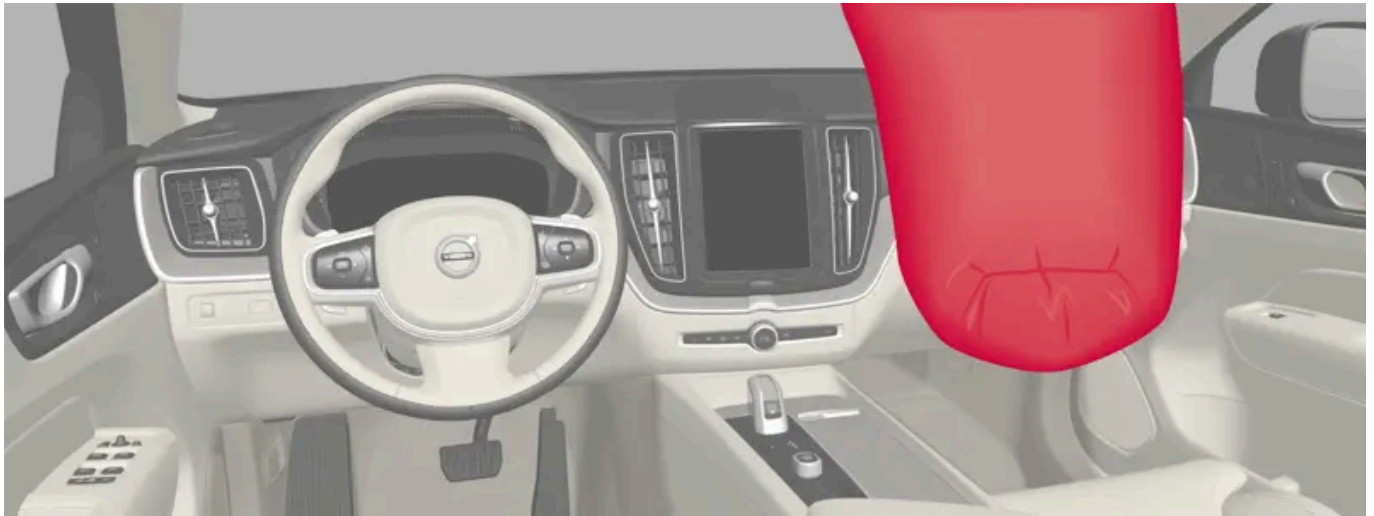
Czołowa poduszka powietrzna pasażera przedniego fotela.
