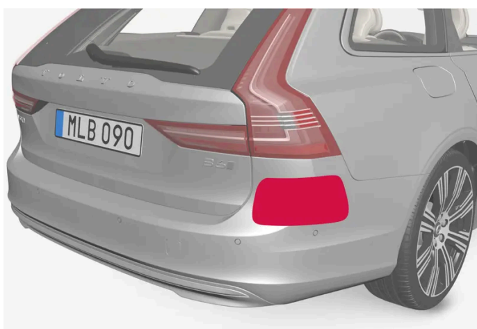
Umieszczenie tylnych modułów radarowych
