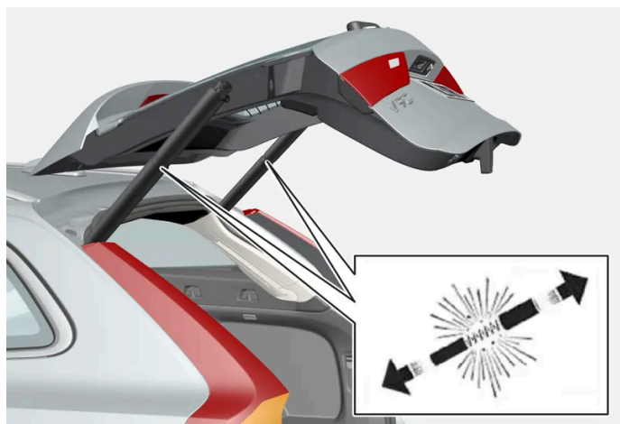
Sprężyny gazowe do sterowanych elektrycznie drzwi bagażnika.
