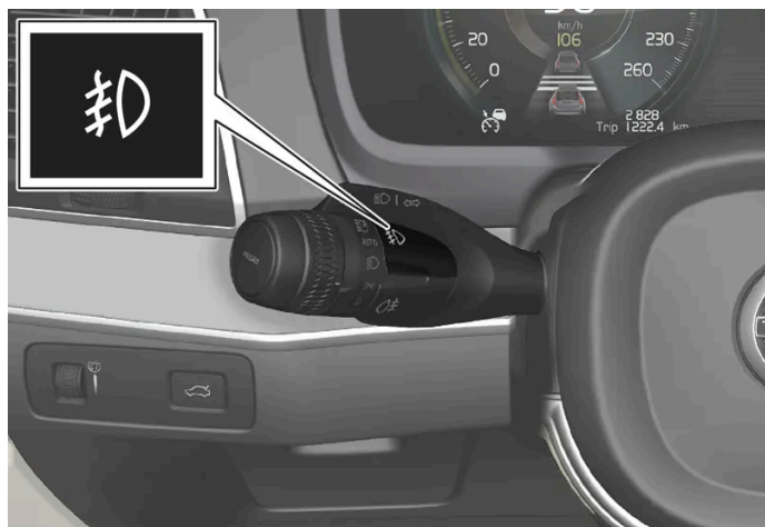
Wyłącznik przednich światła przeciwmgielnych.
