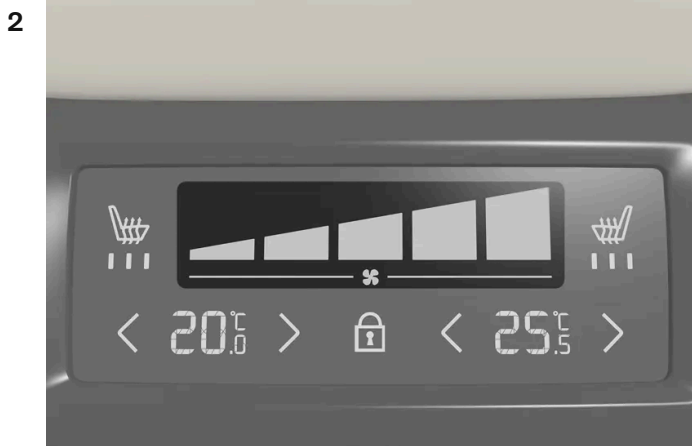
Przyciski wentylatora na panelu klimatyzacji z tyłu konsoli między fotelami.
