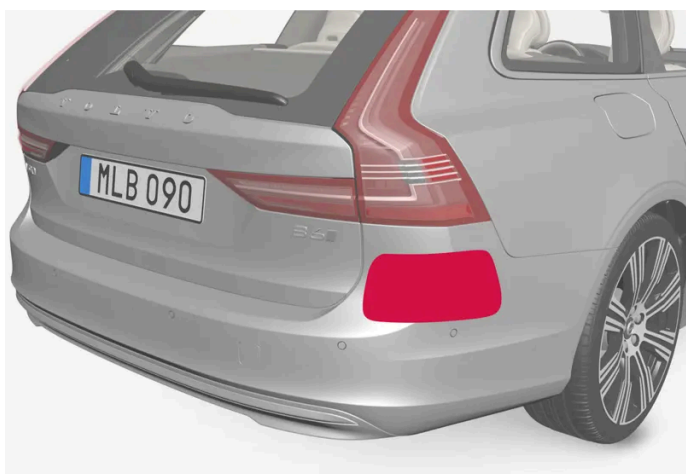
Umieszczenie tylnych modułów radarowych
