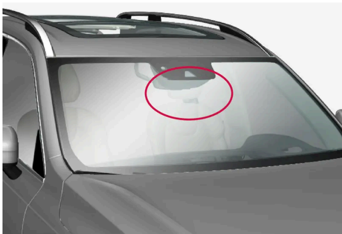
Umieszczenie przedniego modułu kamery
