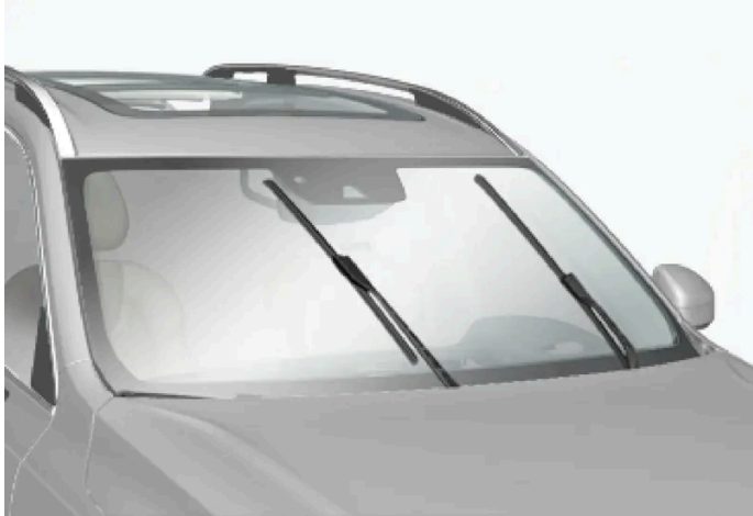
Pióra wycieraczek w pozycji serwisowej.
