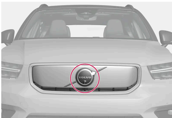
Umieszczenie przedniego modułu radarowego
