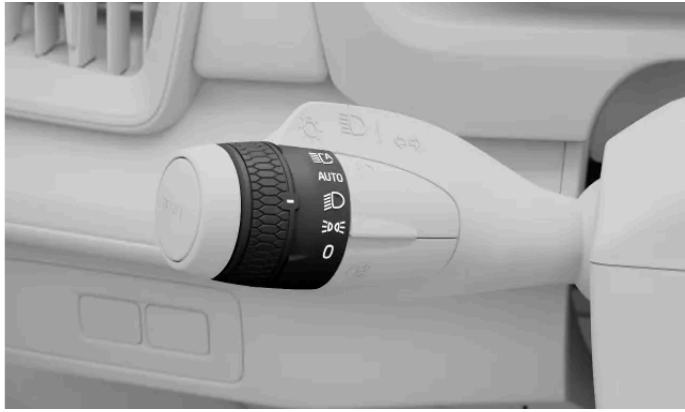
Symbol światła mijania na pierścieniu obrotowym na lewej dźwigni
