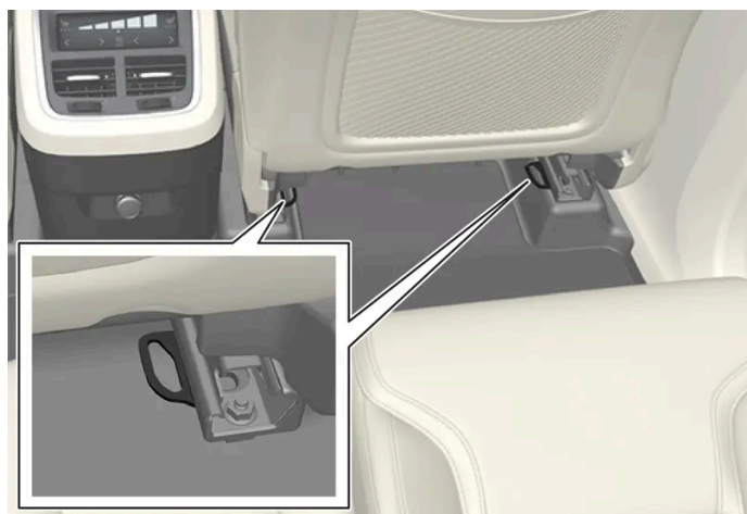
Rozmieszczenie zaczepów mocujących w drugim rzędzie siedzeń.
