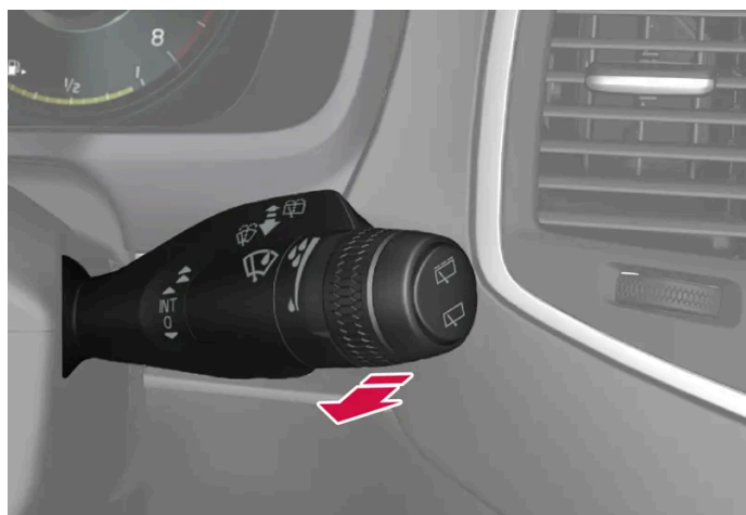
Funkcja spryskiwaczy, prawa dźwignia przełącznika zespolonego.
