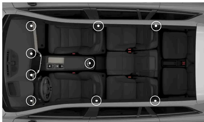
Rozmieszczenie regulowanych nawiewów
