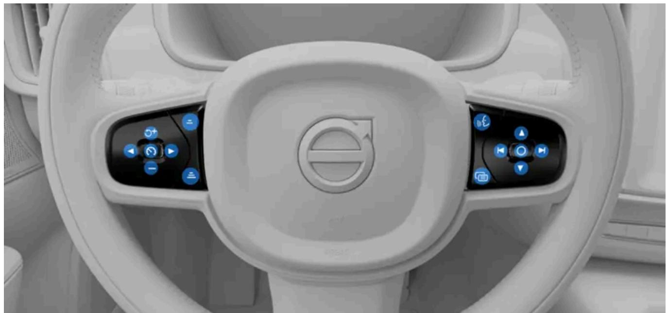
Os botões do lado esquerdo do volante comandam as funções de apoio ao condutor.
