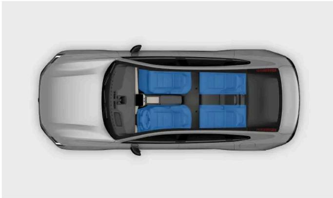
Existem diferentes zonas de climatização no habitáculo do seu automóvel. Por predefinição, todas as zonas estão diretamente sincronizadas com as configurações de climatização definidas pelo condutor. No entanto, as zonas traseiras podem ter as suas próprias configurações de temperatura.
