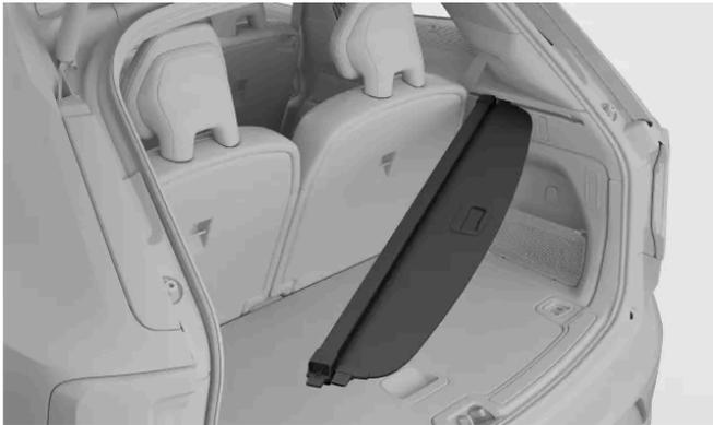
Coloque a extremidade da cobertura de carga na reentrância na ranhura de um dos lados do porta-bagagens. A reentrância está realçada com uma linha de marcação. Assegure-se de que a extremidade da cobertura de carga fica alinhada com a linha de marcação.
