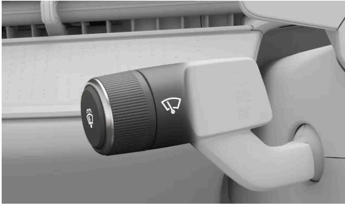
Pode comandar o lava e limpa-para-brisas utilizando o anel rotativo e o botão na alavanca do lado esquerdo do volante.
