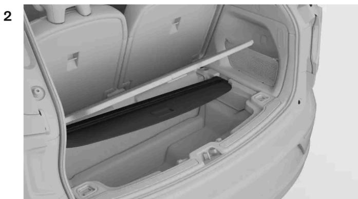
Coloque a extremidade direita da cobertura de carga no suporte da cobertura de carga, que se encontra no lado direito do compartimento de carga.
