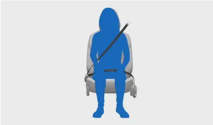
O cinto de segurança bloqueia-se para atuar com sistema de retenção de segurança em determinadas situações. Estas incluem um puxão forte e súbito do cinto, a condução agressiva do automóvel e a presença do automóvel numa inclinação acentuada.
