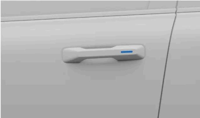
Ao utilizar a sua chave digital, se a função de trancamento de proximidade estiver desligada nas configurações, necessita de trancar manualmente o automóvel. Isso pode ser feito colocando o seu polegar num ponto específico do puxador da porta do condutor.
