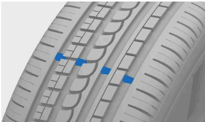
Os sulcos estreitos que acompanham longitudinalmente a banda de rodagem são indicadores de desgaste. O flanco do pneu contém as letras TWI [1].
