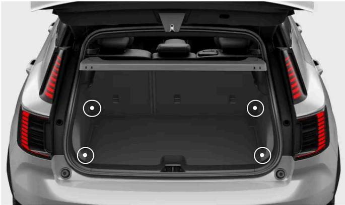
Os olhais de fixação de carga encontram-se nos quatro cantos do porta-bagagens. Pode utilizar os olhais de fixação de carga para fixar correias e prender a carga no porta-bagagens.
