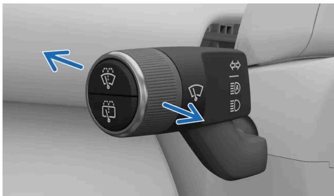
Pode deslocar a alavanca do lado esquerdo para a frente ou para trás para alternar entre as diferentes opções dos máximos. A alavanca recua sempre por ação de mola para a posição neutra.
