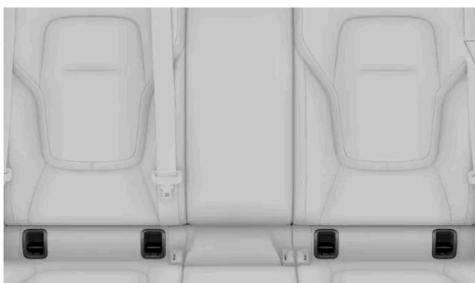
Os pontos de fixação ISOFIX nos bancos traseiros encontram-se atrás de uma aba na parte inferior das costas do banco nos bancos traseiros laterais. A aba tem de ser desdobrada para aceder aos pontos de fixação que se encontram atrás.
