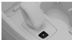
Acione manualmente o travão de estacionamento pressionando o botão do travão de estacionamento.
