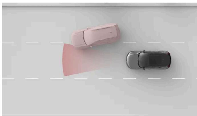
A zona de deteção do radar dianteiro tem uma largura limitada. Caso o seu trajeto seja cortado por outro veículo, a deteção pode ocorrer relativamente tarde, resultando numa resposta súbita do seu automóvel.
