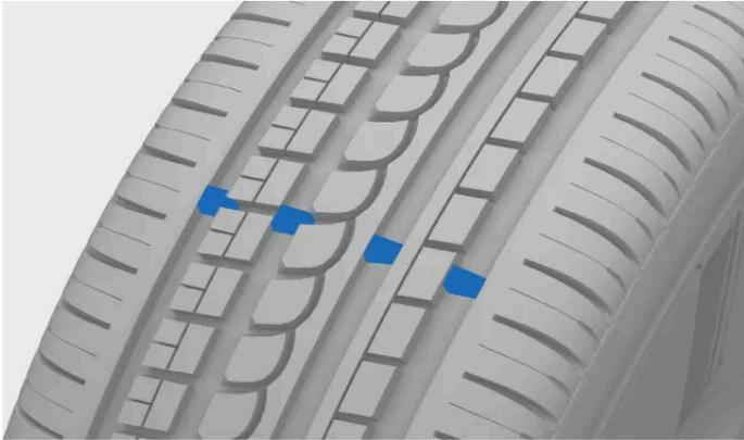
Os sulcos estreitos que acompanham longitudinalmente a banda de rodagem são indicadores de desgaste. O flanco do pneu contém as letras TWI <sup>[1]</sup>.
