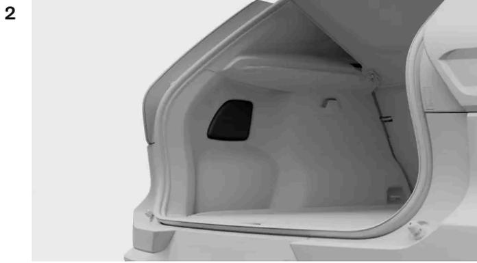
Prima a extremidade superior da tampa do painel para a fazer rodar e retire-a.
