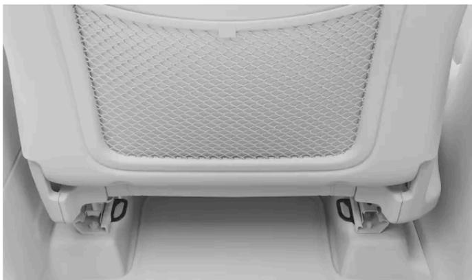
Os pontos de fixação do tirante inferior encontram-se na traseira das calhas do chão dos bancos dianteiros.
