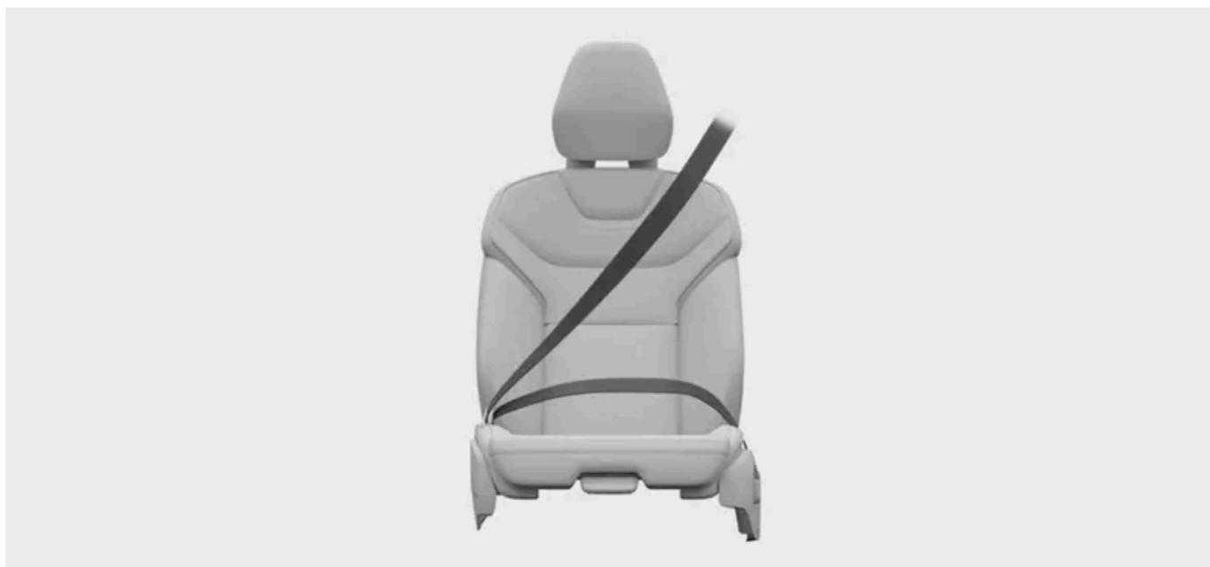
O cinto de segurança bloqueia-se para atuar como um sistema de retenção de segurança em determinadas situações, como quando sujeito a um puxão súbito e intenso, no caso de o automóvel ser conduzido de modo agressivo, ou quando o automóvel se encontra numa inclinação acentuada.
