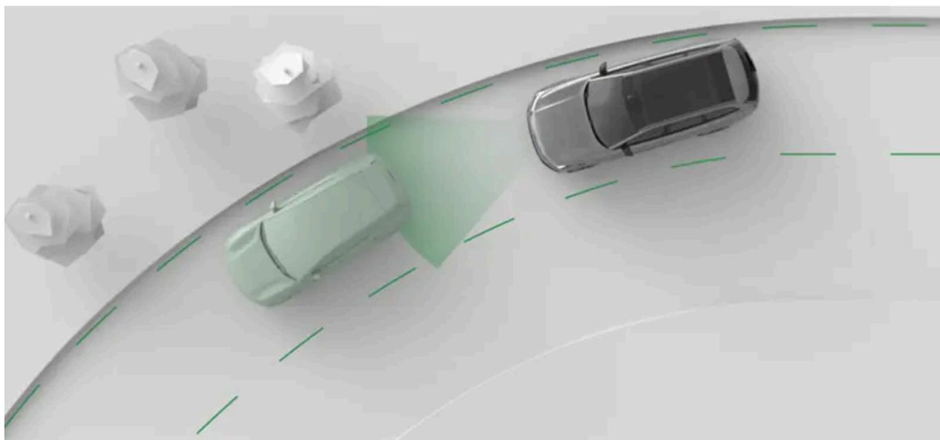
O Pilot Assist orienta ativamente a sua condução numa série de modos. Ao conduzir com o Pilot Assist, seleciona a velocidade-alvo. O automóvel gere então a aceleração e a travagem para ir ao encontro desse valor alvo, enquanto se adapta ainda ao
