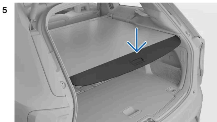
Incline a margem exterior da cobertura de carga para baixo de modo a bloquear na sua posição nas ranhuras.
