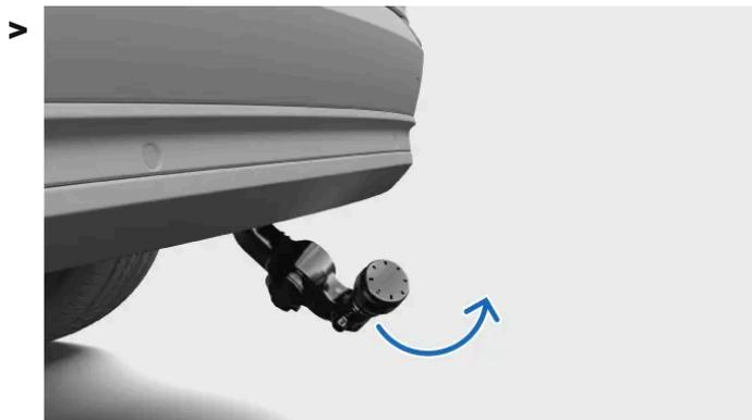
O engate de reboque é instalado. O símbolo no botão de instalação vai piscando à medida que o engate de reboque se abre.
