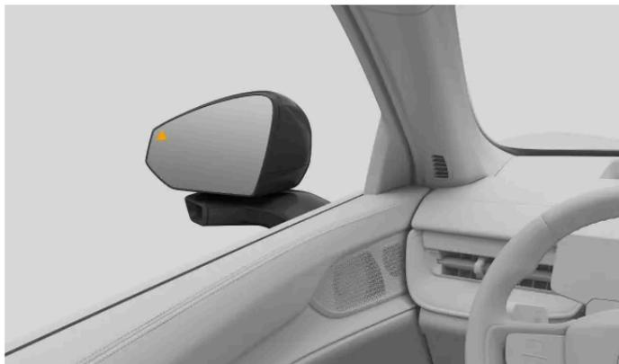
Quando o automóvel deteta trânsito na iminência de passar perto dos lados do automóvel, aparece uma luz no retrovisor lateral. Se começar a abrir a porta no lado do trânsito detetado, o alerta intensifica-se. Um som de alerta pode ocorrer juntamente com alertas visuais, dependendo da urgência do aviso.
