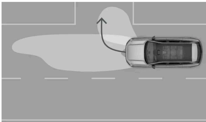
As luzes de curva iluminam a área junto ao automóvel para proporcionar-lhe melhor visibilidade quando curva.
