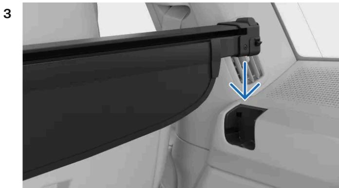
Empurre a cobertura de carga nas reentrâncias até ambos os lados da cobertura de carga encaixarem. Assegure-se de que os fechos estão posicionados com as marcas vermelhas ocultas.
