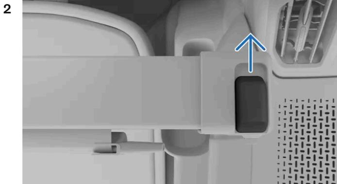
Existem botões de bloqueio nas extremidades da cobertura de carga. Empurre o botão num dos lados para a frente e segure-o enquanto levanta a extremidade da cobertura de carga. Proceda do mesmo modo na outra extremidade da cobertura de carga.
