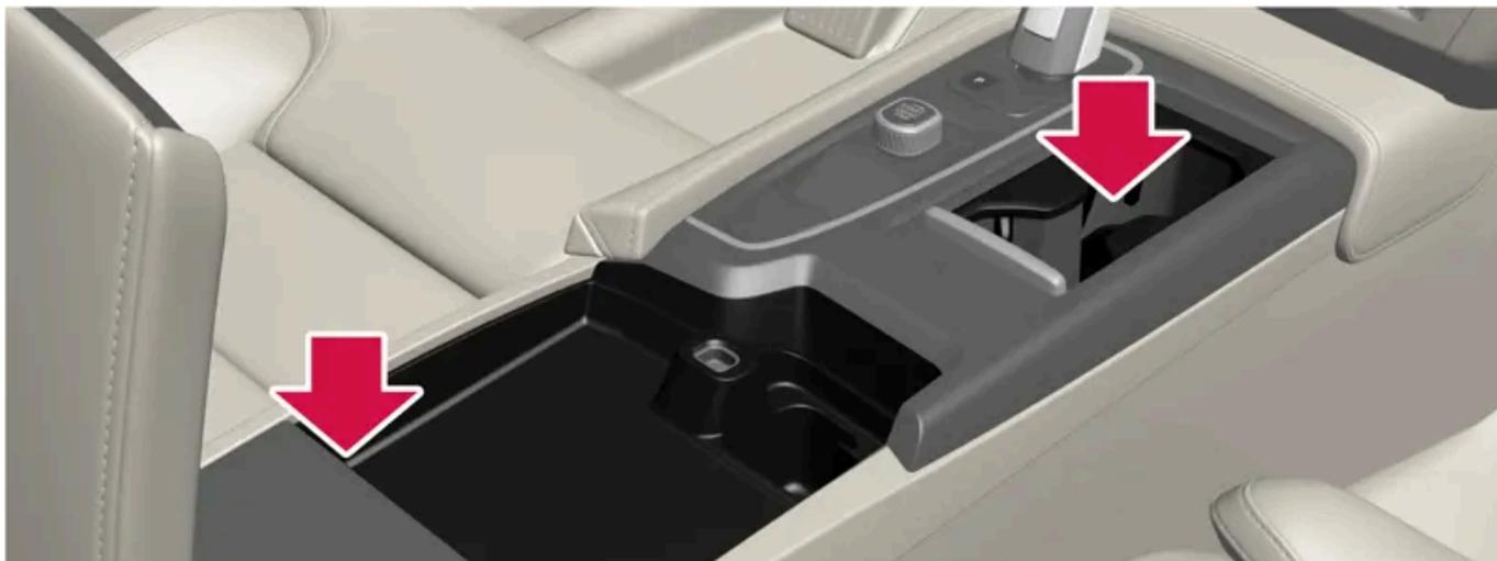
Compartimentos para arrumação com porta-canecas, tomada elétrica e portas USB na consola de túnel.
