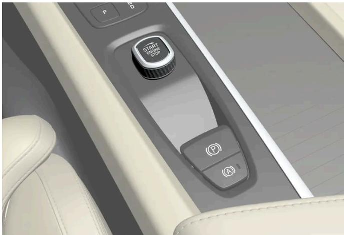
Disco de arranque na consola de túnel.
