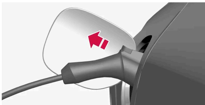
Solte o cabo de carregamento da entrada de carregamento do automóvel e feche a tampa.
