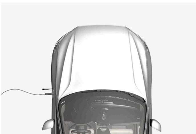
A bateria híbrida é carregada através de um cabo de carregamento, mas também pode ser carregada durante travagens suaves e travagens com o motor na posição de mudanças B. A bateria híbrida também pode ser carregada com o motor de combustão do automóvel. A bateria de arranque do automóvel carrega durante o carregamento da bateria híbrida.
