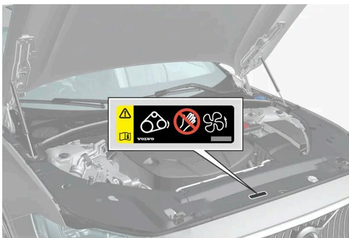
Localização do autocolante de aviso do compartimento do motor. O aspeto do compartimento do motor pode variar consoante o modelo e a variante de motor.
