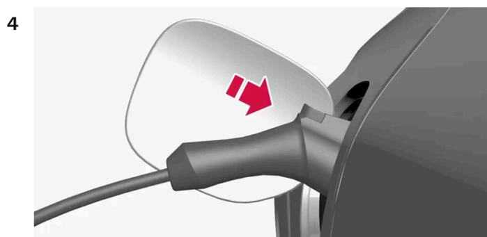
Solte a tampa de protecção da pega de carregamento e encaixe a pega de carregamento até ao fundo na tomada do automóvel.
