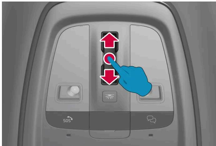
Abrir o teto de abrir – faça uma passagem para trás sobre o comando. O teto de abrir abre até a posição de conforto<sup>[1]</sup>. Para abrir para a posição de abertura máxima – faça uma segunda passagem para trás sobre o comando.
