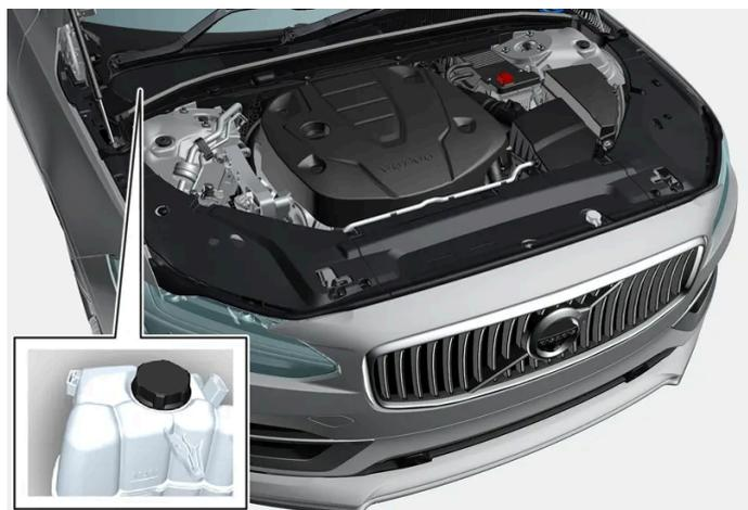
Tanque de expansão para o sistema de arrefecimento, automóvel com volante à direita.
