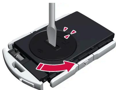
Rode a cobertura da bateria no sentido contrário ao dos ponteiros do relógio para a posição OPEN. Utilize, por ex., uma chave de parafusos ou uma moeda.
