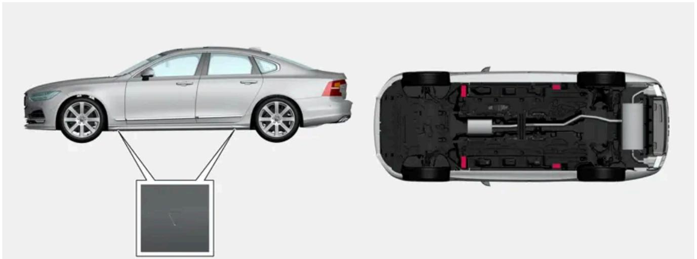
Os triângulos na cobertura de plástico apontam para as fixações do macaco/pontos de elevação (assinalados a vermelho).
