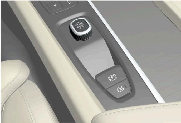
Disco de arranque na consola de túnel.
