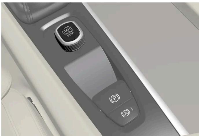
Disco de arranque na consola de túnel.
