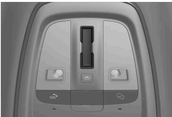
O teto de abrir e a cortina são acionados com um comando que se encontra no teto. O comando é ativado quando o sistema elétrico do automóvel está na posição de ignição I ou II.
