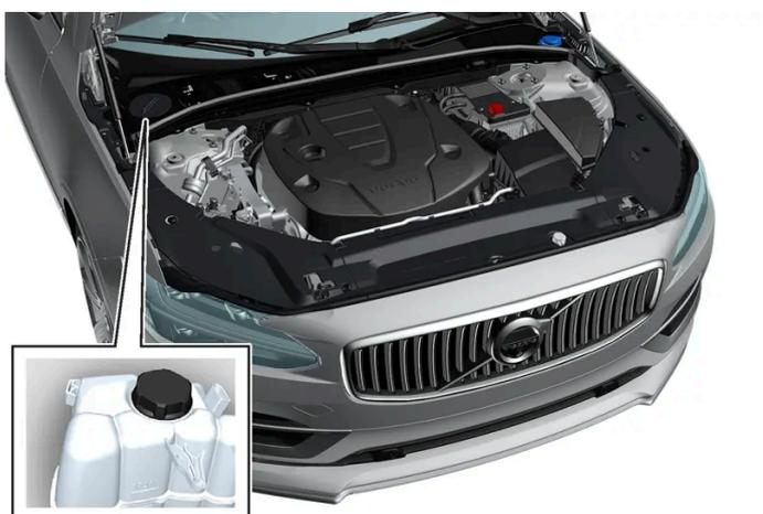
Tanque de expansão para o sistema de arrefecimento, automóvel com volante à esquerda.
