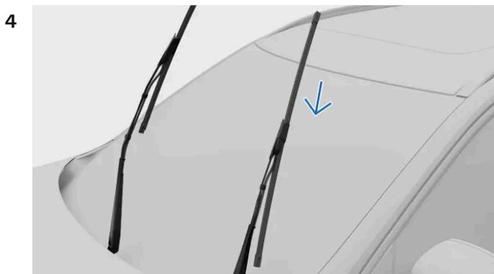
Assegure-se de que a escova do lado do condutor é mais comprida do que a do lado do passageiro. Deslize a escova do limpador no braço do limpador. Assegure-se de que o pino no braço do limpador entra no orifício da escova do limpador. Empurre a escova no braço do limpador até escutar um estalido.
