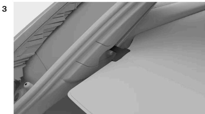
Oriente as extremidades da cobertura de carga para a posição de bloqueio nas ranhuras.
