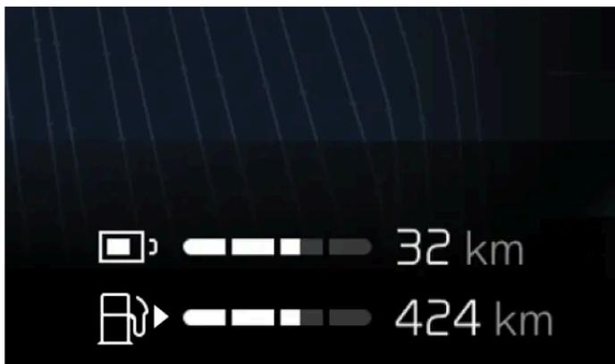
A sua autonomia está relacionada principalmente com a bateria do seu automóvel, a quantidade de combustível que resta no depósito de combustível do seu automóvel e as suas práticas de condução, mas as condições externas também podem ser um fator. O nível da bateria e autonomia esperada são apresentados no mostrador do condutor. A autonomia esperada é calculada com base no seu padrão de condução, atual e histórico.
