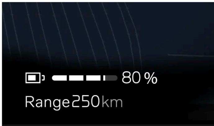
A sua autonomia está relacionada principalmente com o nível da bateria do seu automóvel e o seu estilo de condução, mas as condições externas também são um fator a ter em conta. O nível da bateria e autonomia esperada são apresentados no mostrador do condutor. A autonomia esperada é calculada com base no seu padrão de condução, atual e histórico.
