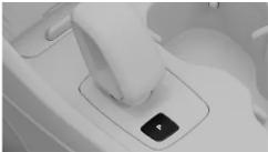
Acione manualmente o travão de estacionamento pressionando o botão do travão de estacionamento.
