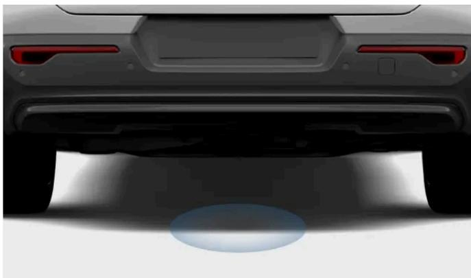
O sensor deteta movimentos sob o para-choques-traseiro. Qualquer movimento detetado destranca o porta-bagagens.
