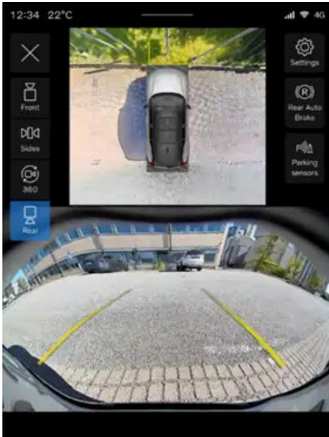
A vista de estacionamento pode apresentar duas vistas ao mesmo tempo. A imagem mostra um exemplo de como pode ficar depois de seleccionar a vista de câmara traseira, que é exibida na metade inferior do mostrador central. A metade superior do mostrador exibe uma visão geral do ambiente em redor do seu automóvel.
