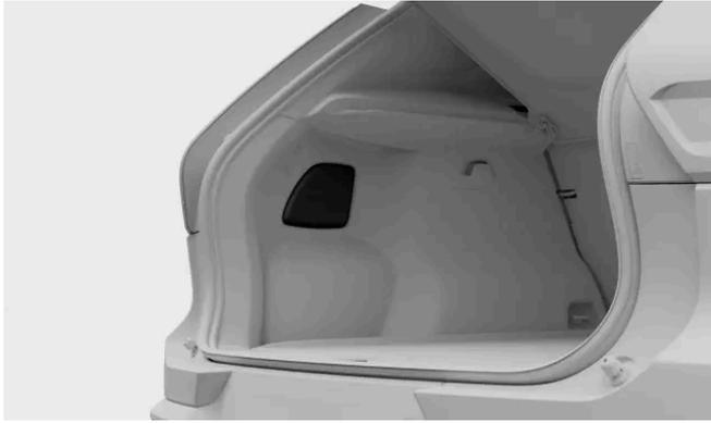
Prima a extremidade superior da tampa do painel para a fazer rodar e retire-a.
