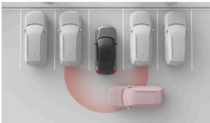
O seu automóvel pode detetar um outro automóvel a cruzar na sua traseira, por exemplo: durante a marcha-atrás para sair de um lugar de estacionamento. Isto permite avisá-lo para que possa abrandar ou travar.
