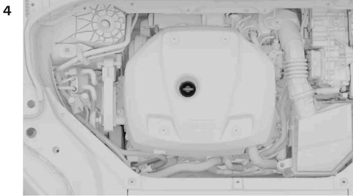
Desparafuse lentamente a tampa para libertar a pressão.
