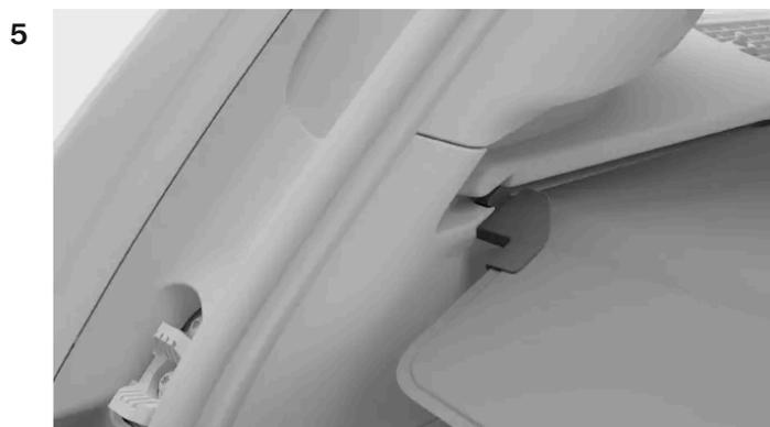
Orienta as extremidades da cobertura de carga para a posição de bloqueio nas ranhuras.
