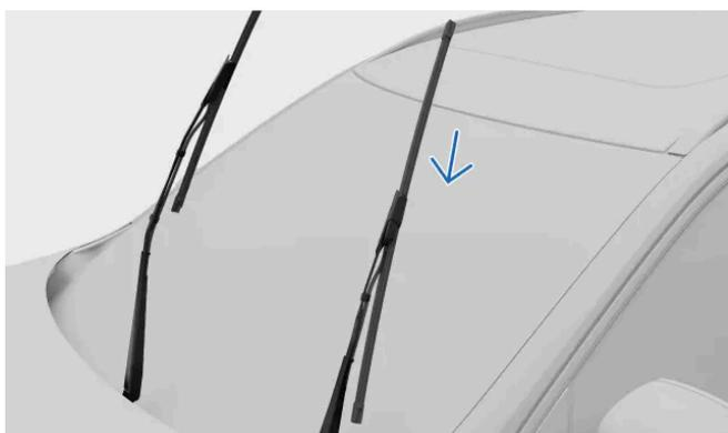
Assegure-se de que a escova do lado do condutor é mais comprida do que a do lado do passageiro. Deslize a escova do limpador de para-brisas no braço do limpador de para-brisas. Assegure-se de que o pino no braço do limpador de para-brisas entra no orifício da escova do limpador de para-brisas. Empurre a escova no braço do limpador de para-brisas até escutar um estalido.
