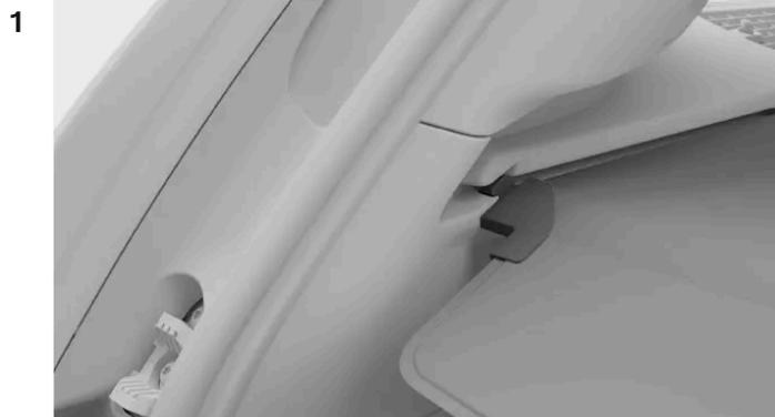
Levante e puxe a extremidade da tela da cobertura de carga pela pega para a desbloquear.
