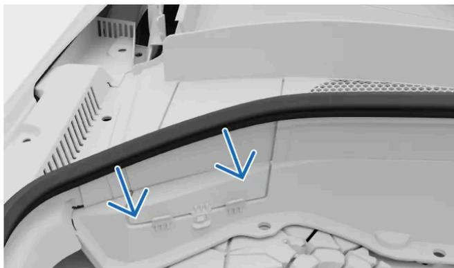
O reservatório do líquido de arrefecimento está localizado no canto superior esquerdo do compartimento do motor, sob uma portinhola do painel. Puxe o vedante de borracha na direção do compartimento do motor para aceder à portinhola.
