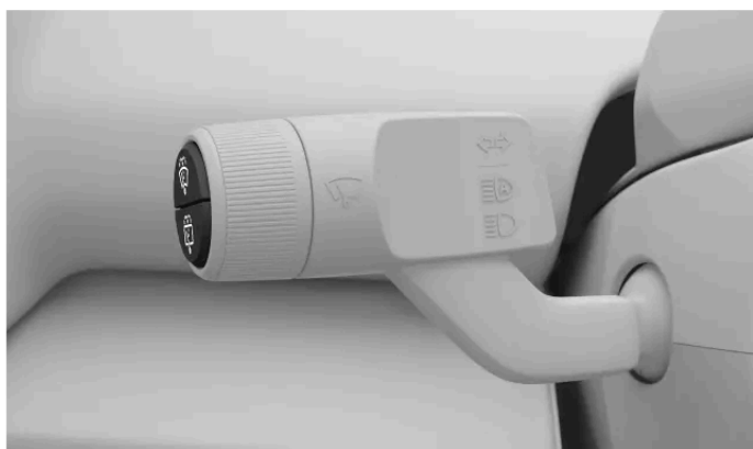
Butoane spălătoare pe maneta din stânga volanului.
