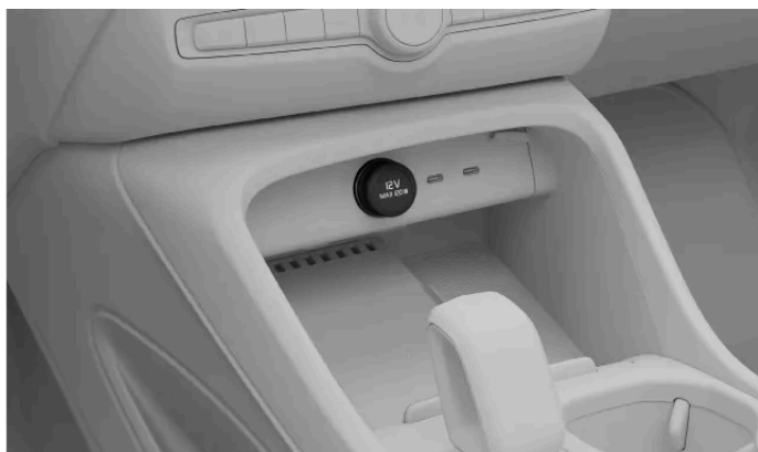
Priza electrică de 12 V din consola tunel
