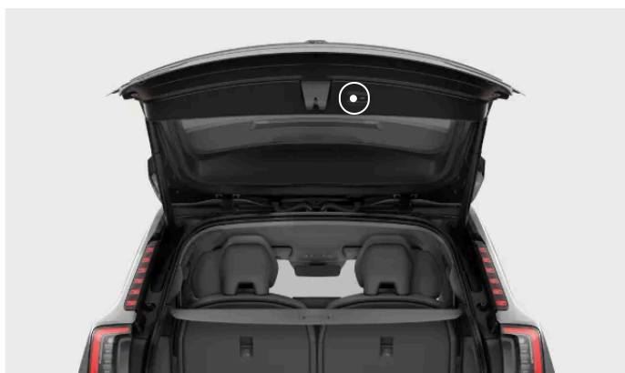
Locația butonului de închidere la portbagajului
