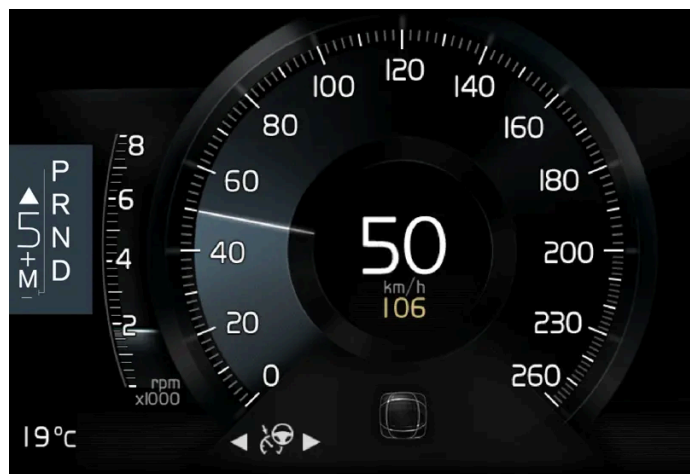
Indicatorul de schimbare a treptei de viteză din afișajul pentru șofer de 8 in la o treaptă de viteză superioară.
