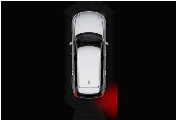
Pictogramă aprinsă pentru Cross Traffic Alert în elementul grafic Sistem asistare parcare de pe ecran.
