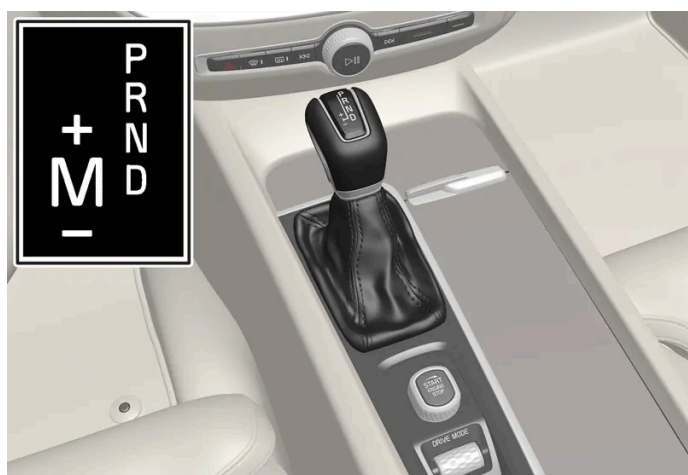
Prezentarea schimbătorului de viteze mare și a comportamentului de schimbare a treptelor de viteză în afișajul pentru șofer.
