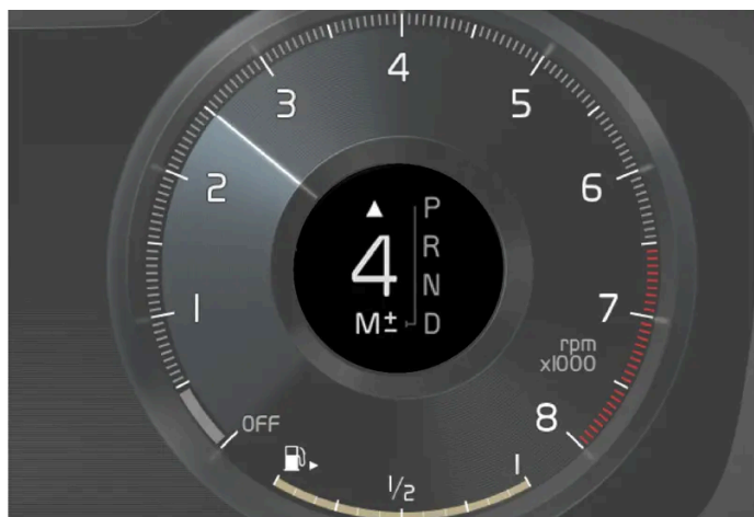
Indicatorul de schimbare a treptei de viteză din afișajul pentru șofer de 12 in la o treaptă de viteză superioară*.
