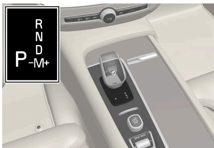
Prezentarea schimbătorului de viteze mic și a comportamentului de schimbare a treptelor de viteză în afișajul pentru șofer.
