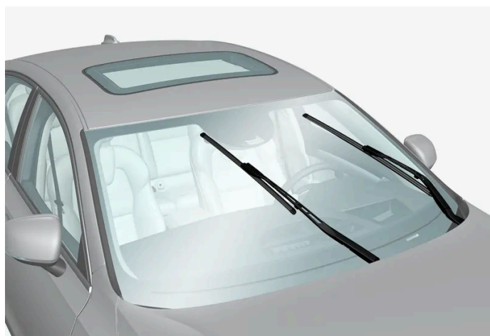
Lamelele ștergătoarelor în poziția de service.
