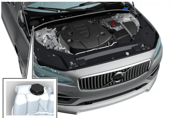
Vas de expansiune pentru lichidul de răcire, mașină cu volan pe stânga.
