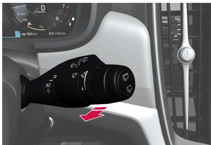
Funcția de spălare, maneta din dreapta
