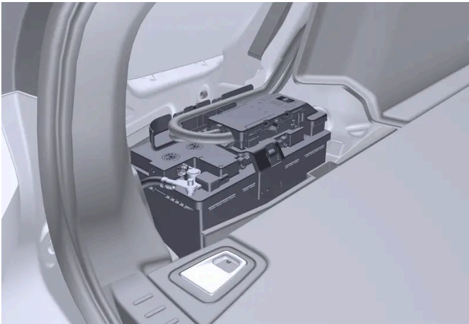
Bateria demarorului se află în compartimentul pentru bagaje.
