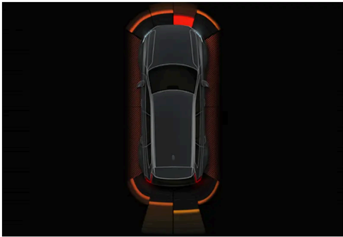
Exemplu de vizualizare a ecranului cu zonele de obstacole și sectoarele senzorilor.
