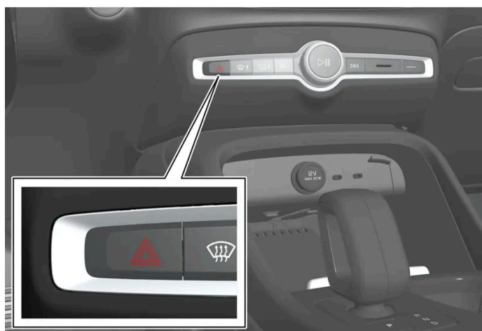
Buton pentru luminile de avarie.
