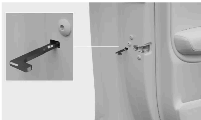
Locația resetării încuietorii
