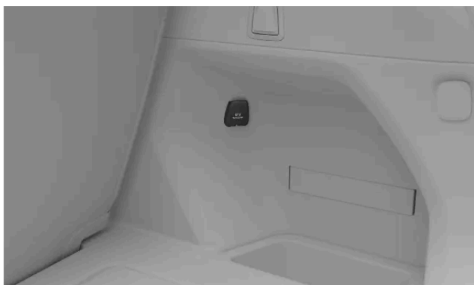
Priza electrică de 12 V din partea dreaptă a portbagajului
