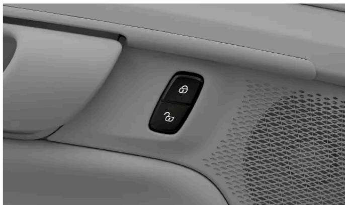
Buton pe portiera față pentru încuierea centralizată
