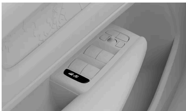
Placering av knapppanelen för barnlåset i dörrpanelen
