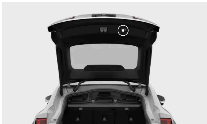
Placering av knappen för stängning av bakluckan
