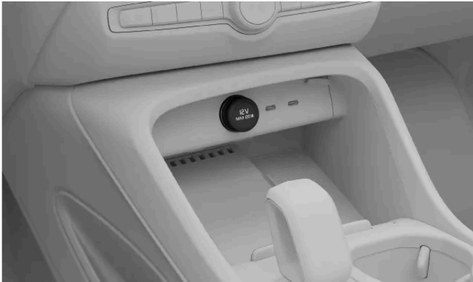
12 V-eluttaget i tunnelkonsolen
