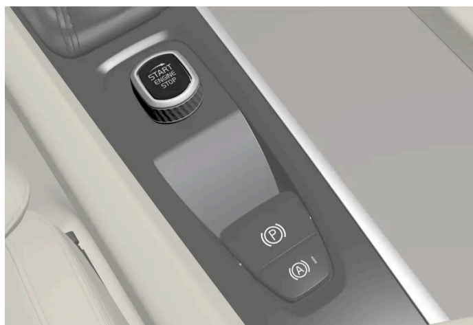
Startvredet i tunnelkonsolen.
