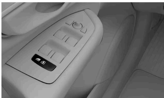
Placering av knapppanelen för barnlåset i dörrpanelen
