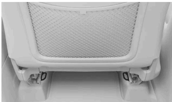
Nedre förankringspunkter sitter på golvskenorna för framsätet.
