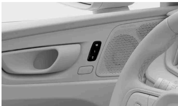
Placering av knapparna för förinställningar av sätesjustering
