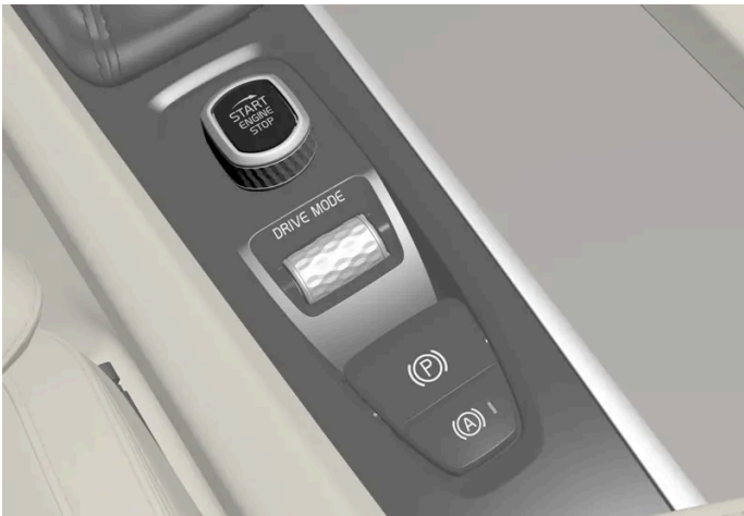
Startvredet i tunnelkonsolen.
