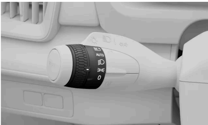
Positionsljussymbolen på vridringen på vänster rattspak
